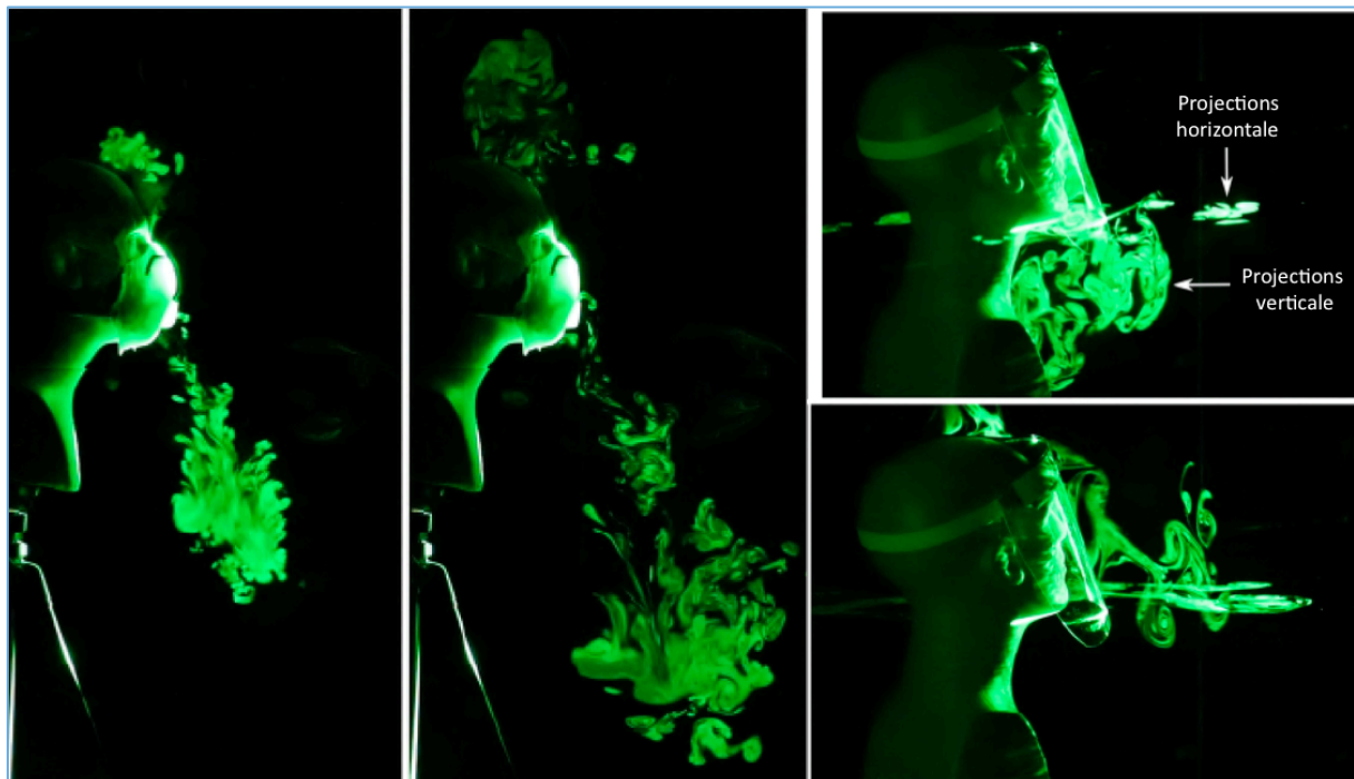
Schéma : visualisation du nuage de gouttelettes expirées par réfraction de la lumière laser pour un masque à valve (à gauche ) et une visière (à droite ).
